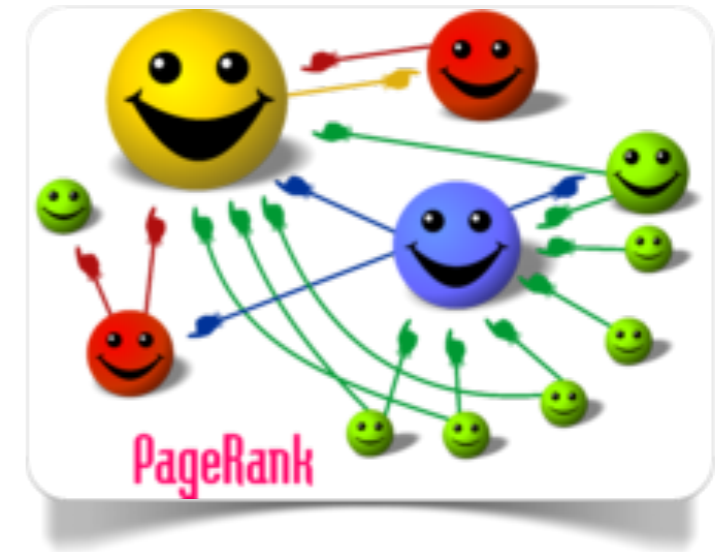
Fig. 3.3 Il Google PageRank, che misura la popolarità dei siti, si basa anche sull'indice indegree
